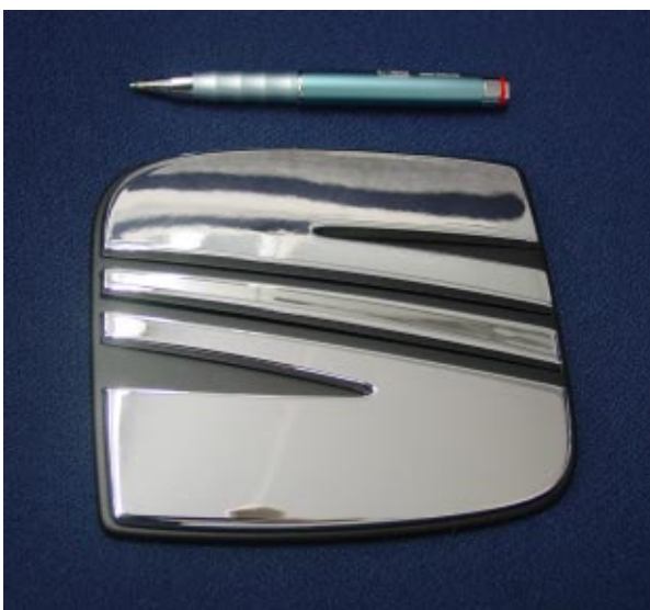
Piezas fabricadas por sinterización de poliamida (SLS).
